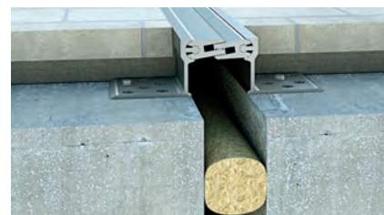
Profilo per giunti strutturali + Cordone tagliafuoco
