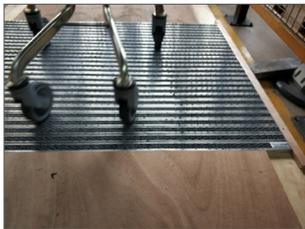
Cet essai est réalisé en faisant circuler un chariot chargé d'un poids de 80 kg sur un tapis d'entrée technique Novomat® 15 finition textile sur un parcours de 3 mètres aller-retour. Après 100 000 cycles, on constate qu'il n'y a pas de dommage et qu'il n'existe aucun dommage structurel sur l'aluminium et que la moquette présente une usure normale pour l'emploi.
