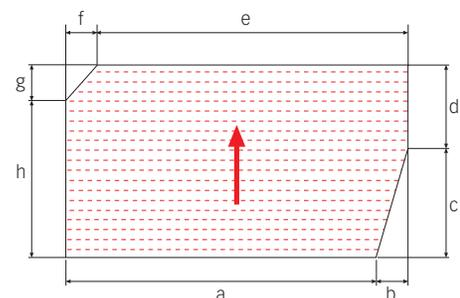
La longueur maximale que l'on peut fournir est de 3 ml. Pour des dimensions supérieures, les tapis d'entrée se réalisent en différentes pièces. Il est fortement recommandé que l'union ne soit pas demandé sur la partie centrale, car il s'agit de la zone de plus haut transit. Il est plus convenable de laisser les unions sur les côtés.
