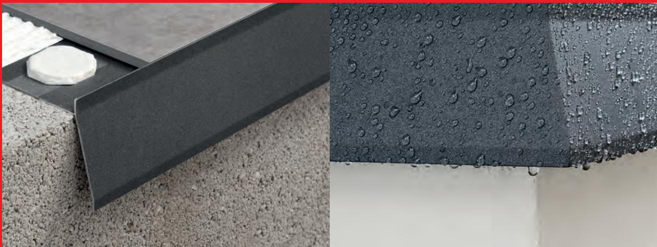
Profilé gout d'eau fabriqué en aluminium, idéal pour les finitions des terrasses, des balcons et des rebords, le dessin exclusif de son rejet d'eau, rainuré dans toute sa longueur, c'est très efficace pour canaliser l'eau loin du mur, évitant ainsi l'écoulement sur la façade. Il dispose des pièces d'angle et de couvre d'union pour une finition parfaite.
