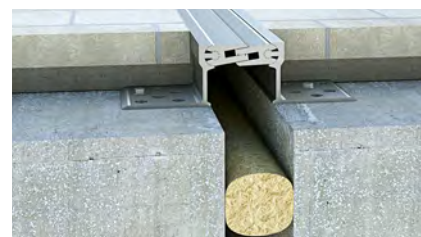
Profilo per giunti strutturali + Cordone tagliafuoco
